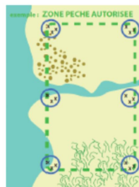
Fig.1 : stratégie d'échantillonnage : une zone de 100m X 50m est décrite par 6 stations positionnées selon un maillage de 50m. Trois réplicats sont réalisés au hasard dans chaque station.
